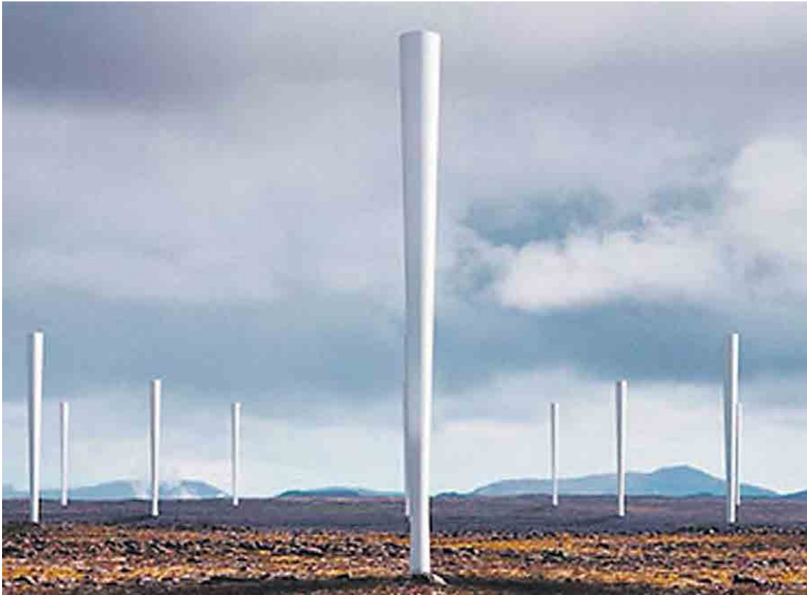
Рис. 2. Стержневая ветрогенерирующая установка (проект). Пока экспериментальный образец имеет в высоту 3 метра.
